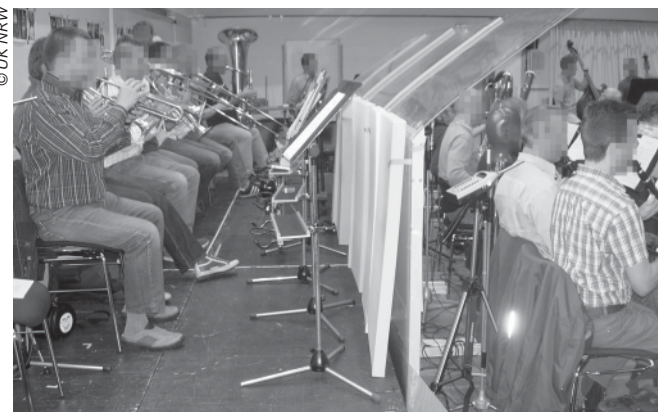
Abb. 2: Von der PTB entwickelter Schallschutzschirm im Praxistest.
