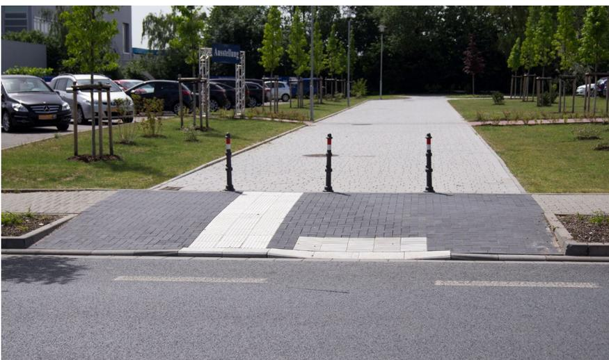
Abb. 51 Abgesenkte Bordsteinkanten sind für Rollstuhl- und Radfahrende gleichermaßen gut geeignet.
