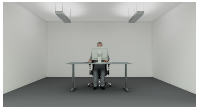
Abb. 17 Beispiel für Indirektbeleuchtung
