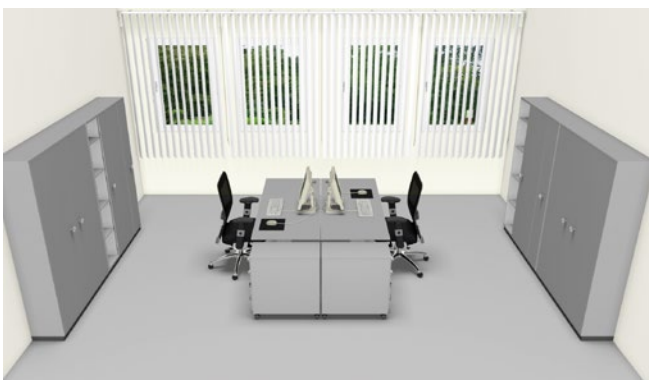
Abb. 9 Empfohlene Aufstellung der Arbeitsplätze zum Fenster
