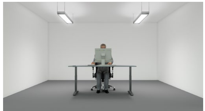
Abb. 19 Beispiel für Direkt-/Indirektbeleuchtung
