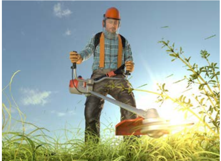
Abb. 8 Einsatz eines Tragegurt- systems bei der Arbeit mit einer Motorsense oder einem Freischneider
