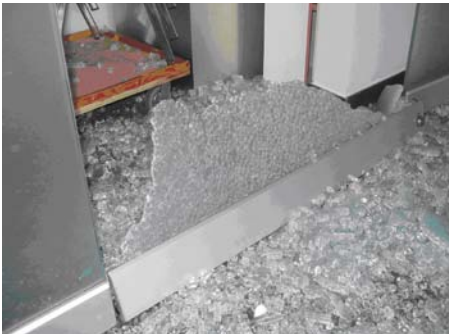
Abb. 1 Schollenbildung nach ESG-Bruch
