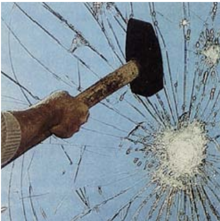
Abb. 2 Verbund-Sicherheitsglas schützt vor Verletzungen durch Binden der Glasstücke bei Bruch.
