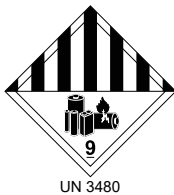
Abb. 11 Gefahrgut-Kennzeichnung von Lithium-Ionen-Batterien
