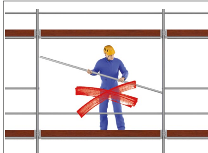
Veränderungen am Gerüst nur durch den Gerüstersteller ausführen lassen
