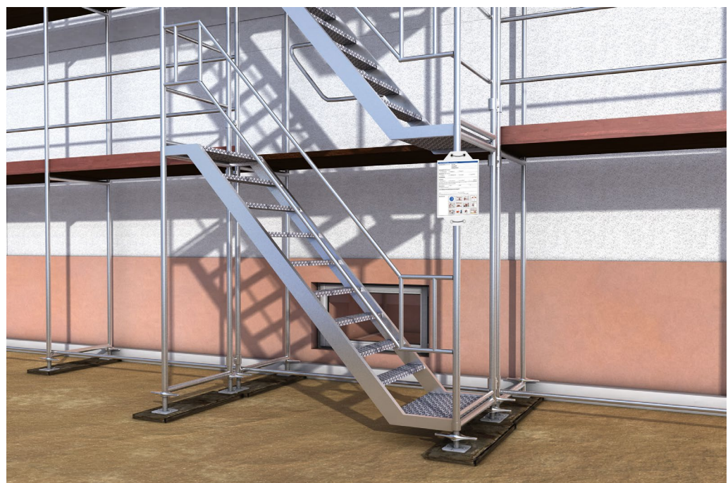
Abb. 10 Beispiel für die Anbringung des Prüfprotokolls, der Kennzeichnung und des Planes für den Gebrauch am Gerüst nach Anhang 7.3
