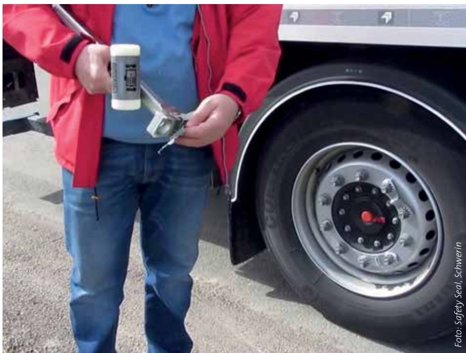
▲ Abb. 9 und 10: Sicherungen für Radmuttern bzw. -schrauben der Fa. Safety Seal mit dem nötigen Werkzeug.
