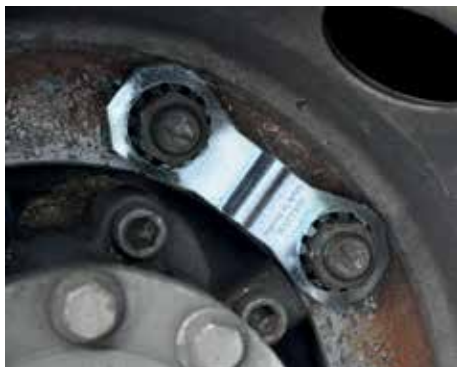
▲ Abb. 9 und 10: Sicherungen für Radmuttern bzw. -schrauben der Fa. Safety Seal mit dem nötigen Werkzeug.
