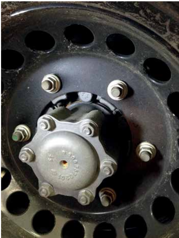
▲ Abb. 4 und 5: Felge auf Radträger und Radträger an der Achse, hier: MB Sprinter 518, EZ 2009.
