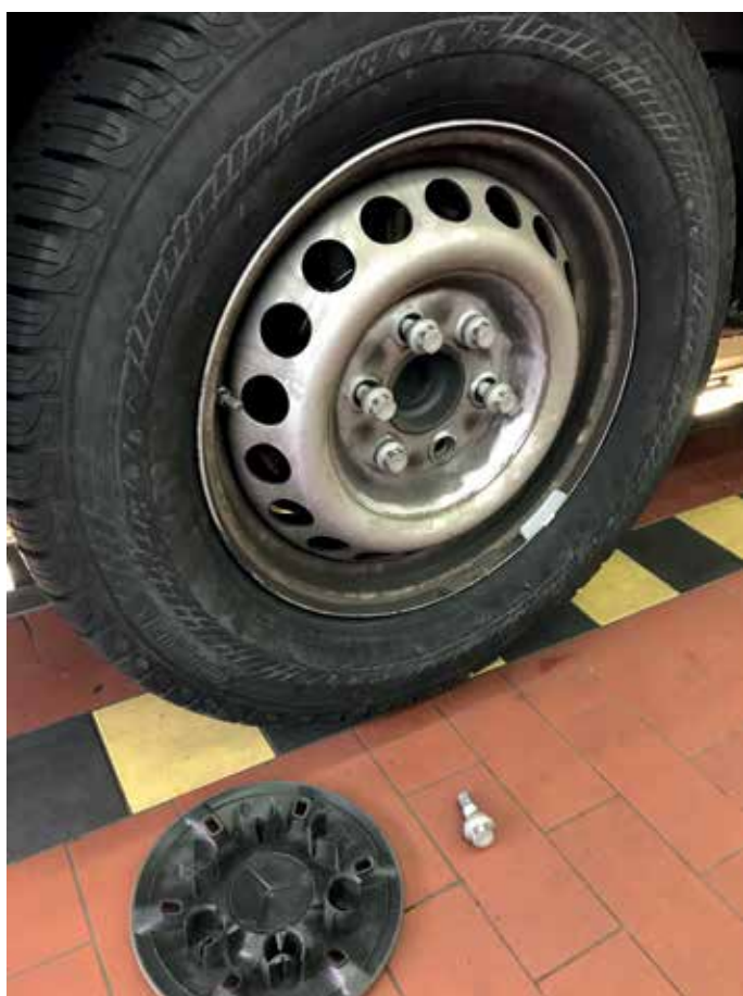
▲ Abb. 6 und 7: KTW auf Transporterfahrzeug der 3,5-Tonnen-Klasse, NCV 3 bzw. Baureihe W 906 BB 35, hier ein MB Sprinter 316, EZ 03/2017 (Fahrstellbaujahr damit 2016). In Abb. 7 sind die Radschrauben gut zu erkennen, die hier schon zum Radwechsel gelöst wurden. Im Gegensatz zum Fünf-Tonner sind die Felgen hier im Fahrbetrieb mit einer Schutzkappe bedeckt.
