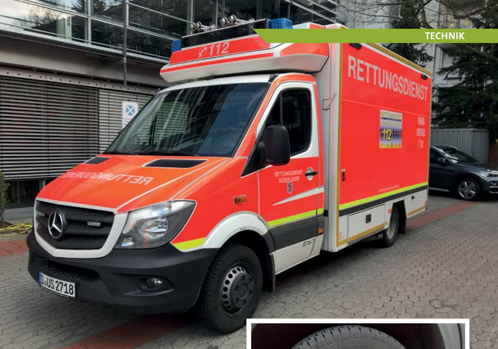
▲ Abb. 1 bis 3: RTW auf Transporterfahrzeug der Fünf-Tonnen-Klasse, NCV 3 bzw. Baureihe W 906 BA 50, hier ein MB Sprinter 519, EZ. 04/2018 (Fahrgestellbaujahr damit 2017). Gut zu erkennen sind die Muttern an der Vorderachse und an Zwillingbereifung hinten.
