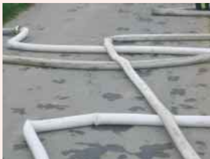
So verlegte Schläuche können zu einer Stolpergefahr werden.
